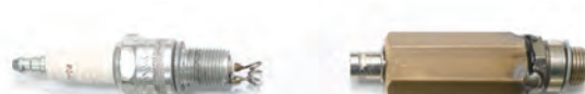
▲ 폭발인화시험용 지그의 커넥터. 기존 커넥터(좌)는 기계마다 모양이 달라 제대로 고정하기가 어려웠지만, 이번에 특허받은 커넥터(우)는 한번의 터치로도 튼튼하게 고정할 수 있다.
